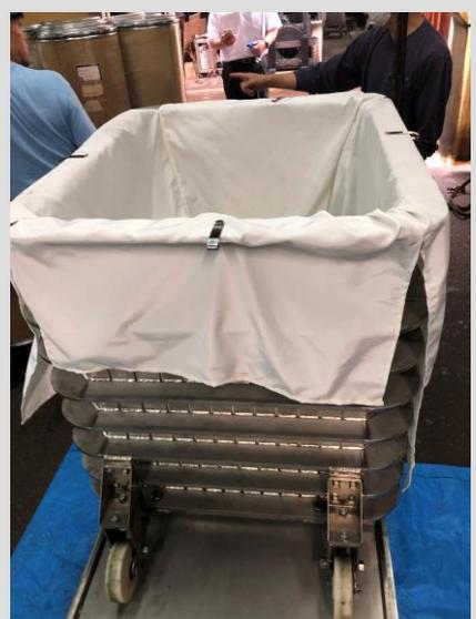
高圧型A-1圧搾機 容積600L 接液部ステンレス製
